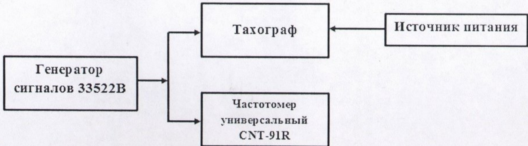
Рисунок 2 – Схема проведения измерений при определении погрешности измерения интервала времени и инструментальной погрешности пройденного пути
