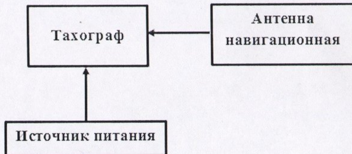
Рисунок 1 – Схема проведения измерений при проверке работоспособности
