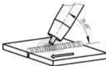
Рис. 8.5. Угол наклона горелки.
