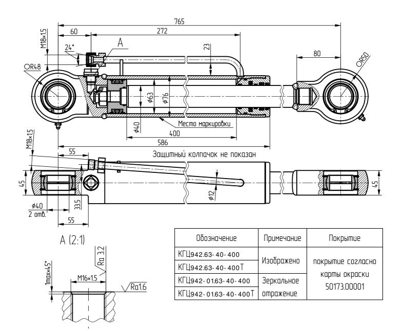
Применяемость: гидроцилиндр рулевого управления погрузчика "Амкодор- 330С2".
