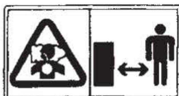
Выхлопы содержат вредный угарный газ. Никогда не эксплуатируйте электростанцию в закрытом помещении. Перед включением убедитесь, что обеспечена хорошая вентиляция. При установке в хорошо проветриваемых зонах обращайте внимание на обеспечение безопасности.
