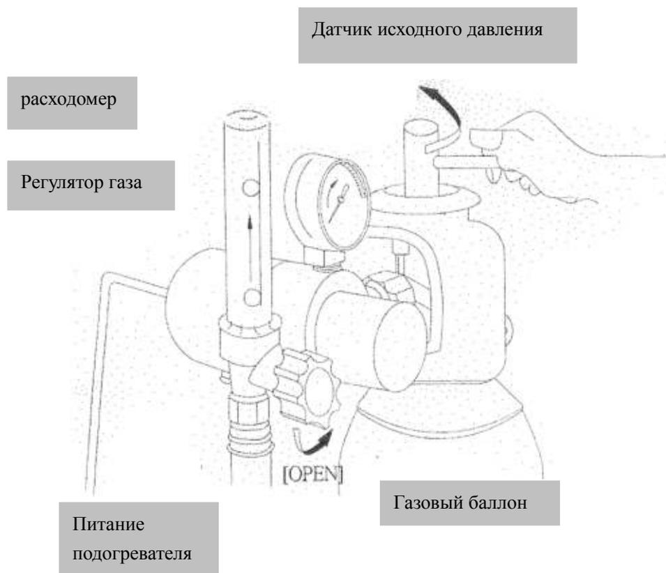
При сварке в углекислой защитной среде следует использовать углекислый газ.
