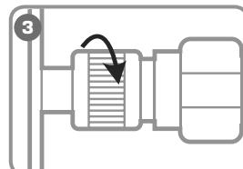
Плотно затяните гайку БРС, приложив достаточное усилие (от руки) для обеспечения хорошего соединения (без применения слесарного инструмента)
