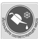
Во время подготовки инструмента к эксплуатации убедитесь, что используемое гидравлическое масло соответствует температуре окружающей среды в месте проведения работы. Проверьте наличие и уровень масла в резервуаре инструмента
