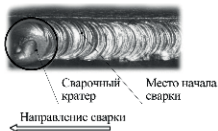
Рис. 8.4. Начало сварки при смене электрода.
